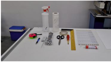
Подгответе необходимите материали - кутия за монтаж, съответен брой и вид LED модули според предварително подготвената схема за монтаж, съответен брой грайвери, съответен брой кабели с конектори (различни дължини), крайни капачки, почистващи кърпи и обезмаслител за повърхности, специално термопроводящо лепило за фиксиране на LED модули D/G330 или D/G50.
