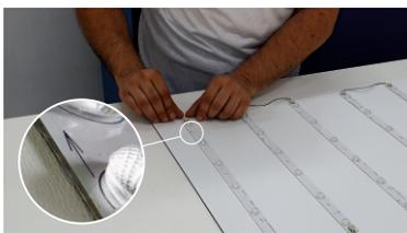
Поставете крайна капачка в свободния извод на последния LED модул във всяко разклонение. Спазвайте правилната посока на окабеляването - то трябва да става по посока на стрелките отбелязани на led модулите, които сочат последователността на свързване от драйвера, през модулите до крайната капачка на последната платка.
